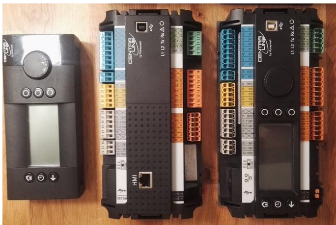
Figur 2 Undersentraler og HMI display
